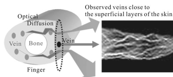
Fig. 1 Light diffusion inside a biomembrane
