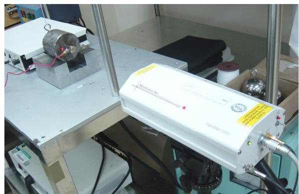
Fig. 1. Laser Doppler vibrometer.
